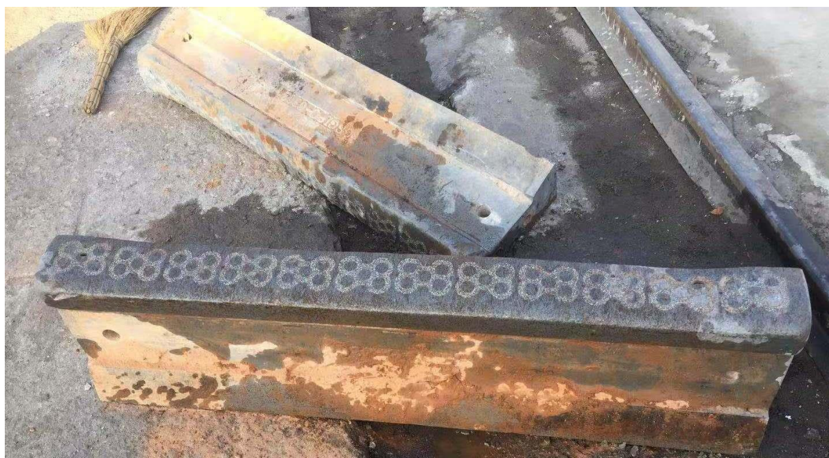
使用 110 小时后，磨损 60mm after 110 hour -abrasion;60mm
