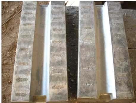
附图-1-5 高 Cr 陶瓷复合板锤外观局部放大图
